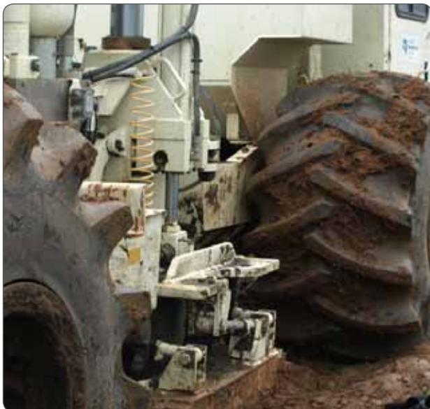
Pav. 2. Naujos AE aikštelėse specialia, 30 tonų sveriančia technika sukeliama žemės mikro drebėjimai.
